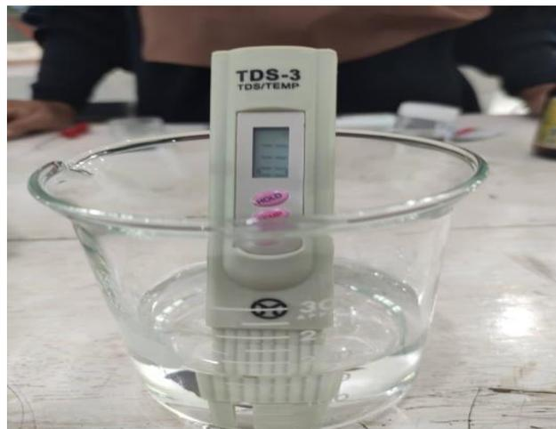
**Gambar 6.** Pengukuran nilai TDS pada Sampel Air 1
