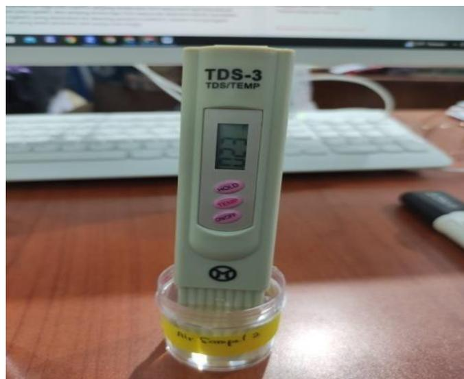
**Gambar 7.** Pengukuran nilai TDS pada Sampel Air 2
